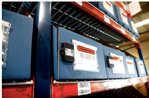
La start-up UWINLOC développe des solutions de traçabilité, de localisation et de digitalisation des flux. Grâce à une technologie innovante d'étiquettes connectées sans pile, l'entreprise toulousaine propose aux entreprises de la logistique, de l'industrie et de la distribution, de tracer tout type d'objets de manière continue et précise.
